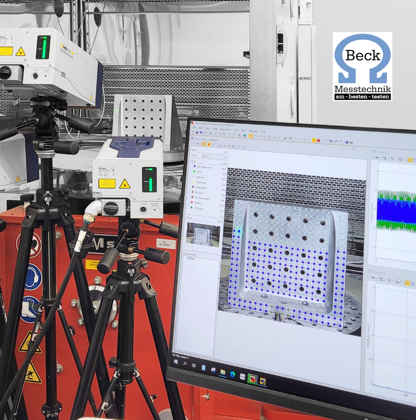
3 Versuchsaufbau zur experimentellen Modalanalyse mittels elektromechanischem Shaker bei der Firma Beck-Messtechnik, einem renommierten Messtechnikspezialisten für Umweltsimulation. Neben dem Shaker ist ein Qtec 3D-Scanning Vibrometer zu sehen. Im Vordergrund ist die Mess- und Auswertesoftware PSV sichtbar.
